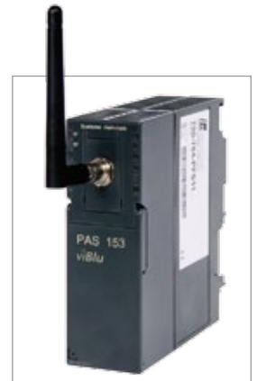
PAS 153 viBlu, Slave PROFIBUS con interfaccia radio
