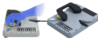
L'ERP400S TP opzionale integra una chiave di abilitazione a 3 modalità per una maggiore sicurezza
